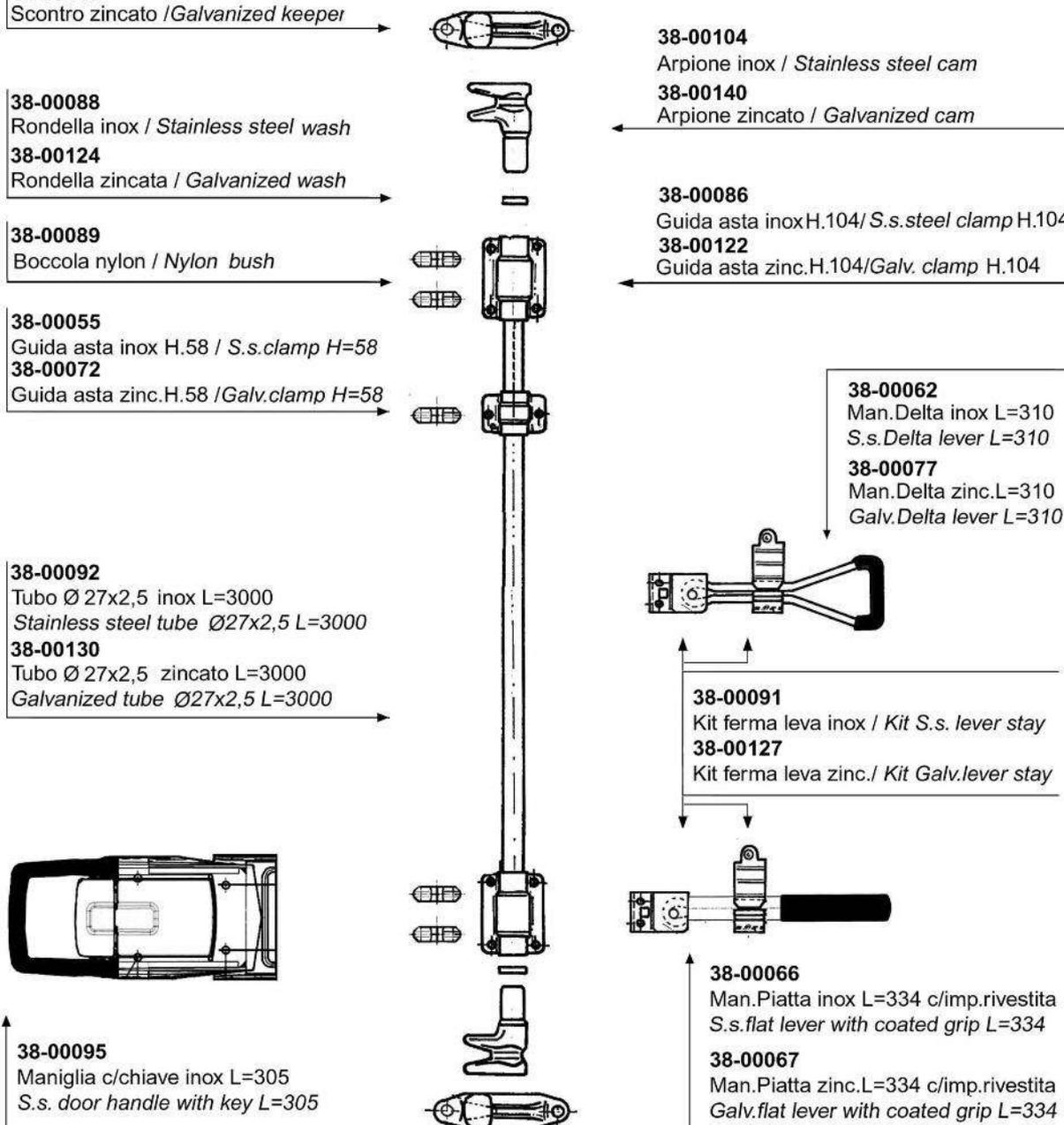
**Componenti per chiusure esterne tubo D.27*****Components for external door handles for D.27***
