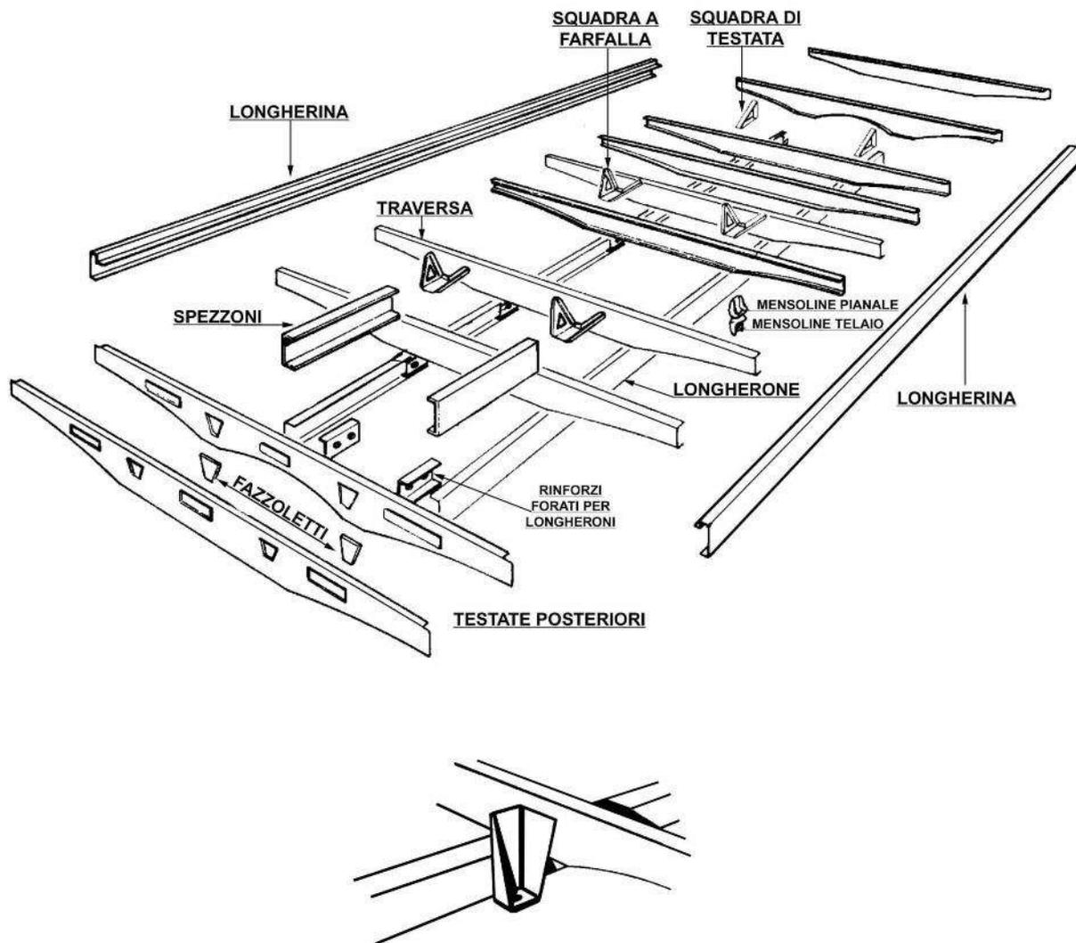
Mensoline per ancoraggio carrozzerie e rinforzo congiunzione traverse a longherone (adatto per gamma S e gamma Z)
